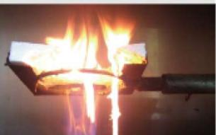
発泡プラスチック系の断熱材
