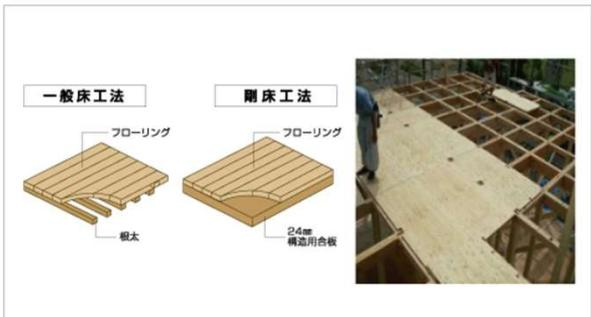
「剛床工法」とは、根太を設けず床下地合板を厚くして、直接梁材に留め付ける床組み工法で、一般的な「根太床工法」に比べ地震や台風時に発生する水平力に対して強い造りです。また床を厚くすることでたわみが減少し、床鳴りが発生しにくくなると同時に、耐火性能も上がります。
